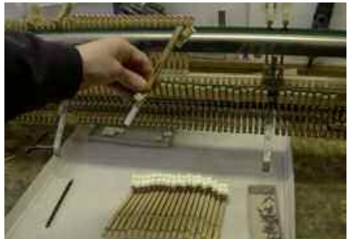
**Bild 2: Einschrauben der neuen Dämpfer**
